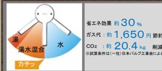
よく使われるレバー中央位置で水を優先して吐水し、水と湯の境にクリック感を設けることで、湯水をきちんと使い分け、ムダなガスや電気の使用を防ぎます。
