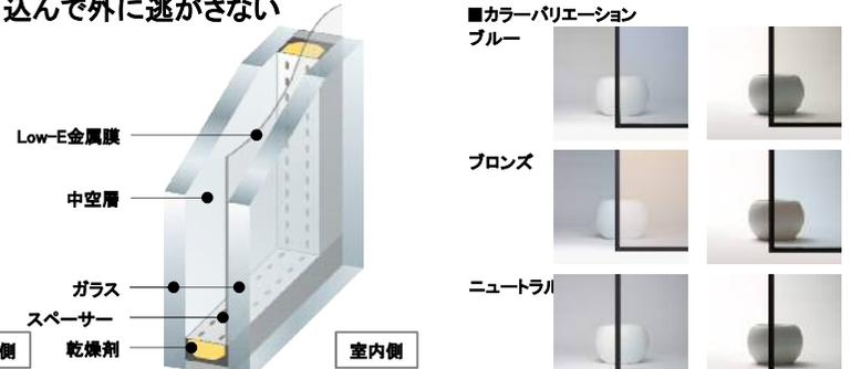
室内側ガラスをLow-E金属膜でコーティングすることによって暖かい太陽光を取り込み、室内の暖房熱を逃がさない複層ガラスです。
