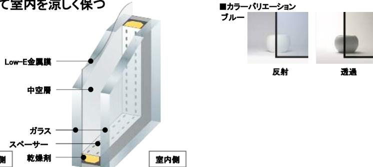
室外側ガラスをLow-E金属膜でコーティングし、太陽の熱線を約50%カット。冷房効果を高め、西日対策や紫外線による室内の色褪せ防止になります。
