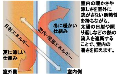
■遮熱性 真夏の強い太陽熱を外側で反射。
